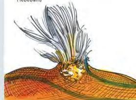
Durch Schnitte beschädigte Ummantelung einer Rundschlinge
