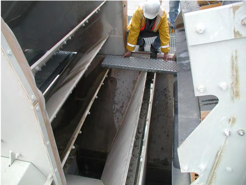
Abbildung 32: Mobile Arbeitsplattform für die Siebinstandhaltung
