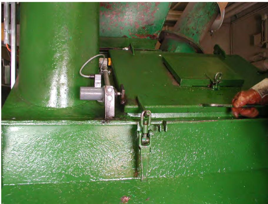
Abbildung 28: Endschalter mit Verriegelung bei Mischerdeckel
