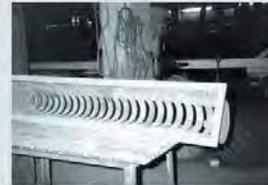
Es wurde eine flexible Verkleidung für Untergurtrollen entwickelt, die oben genannte Nachteile nicht mehr aufweist. Die neuartige Verkleidung besteht aus einem rechteckigen Rahmen zur Befestigung am Bandgerüst, einer halbkreisförmigen, daran befestigten und mit Schlitzfenstern versehenen Gummimatte aus einem gebrauchten Fördergurt sowie seitlich angebrachten Lochblechen.
